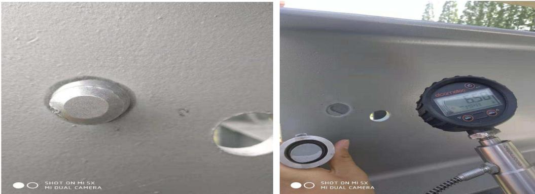
拉开法附着力检测结果 6.5MPa，远远大于国家标准要求的 3MPa。
