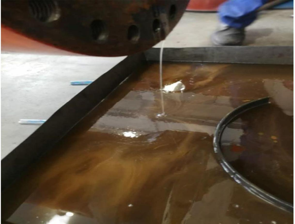
图 4 冲沙底孔油缸内液压油质污染严重，颜色发黑，有蛋清状漂浮物
