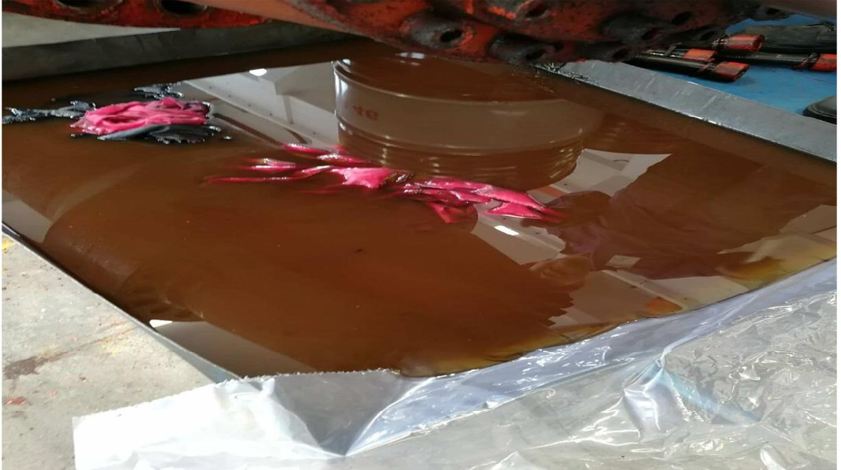
图3 表孔油缸内液压油质污染严重，颜色发黑，有蛋清状漂浮物
