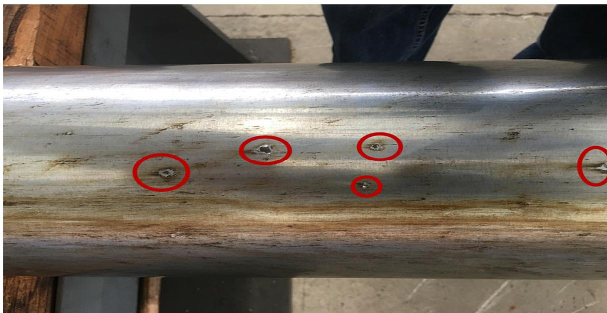
图 1 表孔活塞杆表面镀铬层腐蚀，脱落
