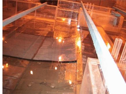
图 7.1 消力池底板失稳试验模拟示意图 照片 7.1 消力池稳定试验失稳掀起的板块位置
