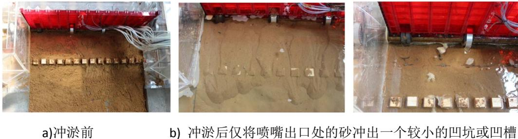
图 8.1 一般高压冲淤管冲淤前后照片图
