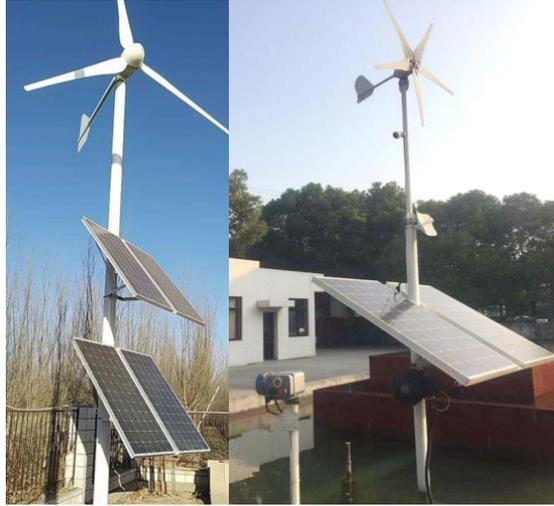
图7 基于风光互补直流驱动系统实物图。
