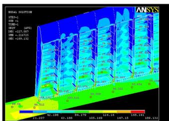
图 2.4 闸门应力分布云图（局部放大）
