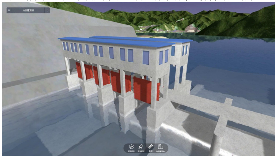
图 6 启闭机房布置仿真模拟
