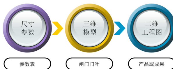
图 2 三维参数化的基本原理
