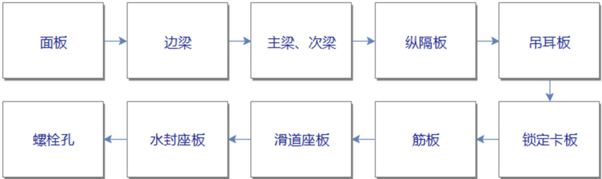
图 6 门叶板梁设计的一般顺序
